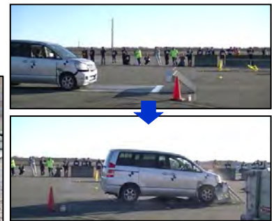
無人車両による衝突試験の様子
