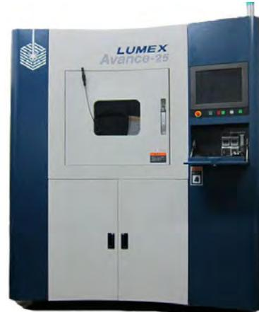
図 1 工業試験場に設備導入した金属 3D プリンタ
