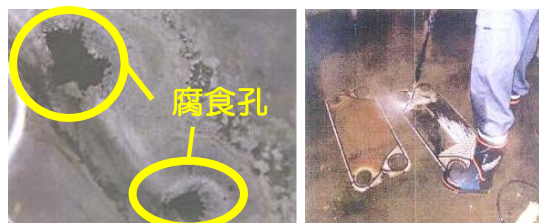
腐食による水の漏洩 分解・洗浄が手間 金属製プレート熱交換器の問題点
