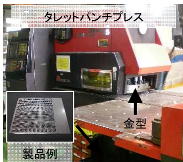
図1 汎用金型による板金加工例
