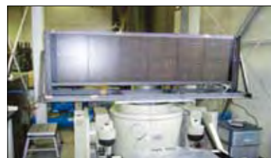
振動試験装置によるランダム振動試験
