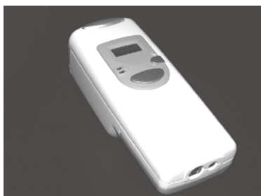
新型 携帯型近赤外水分センサの外観 (幅80×奥行208×高さ63mm、重量530g)
