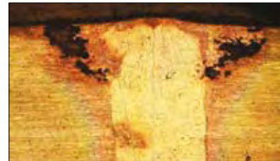
溶接部に発生した腐食(断面組織写真)
