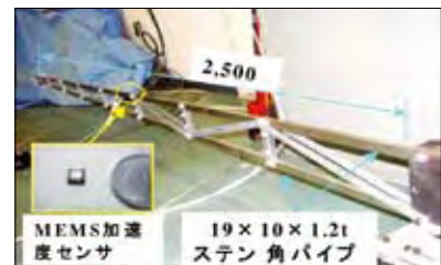
試作したトラス構造作業アーム(2.5m)
