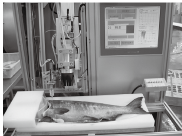
等級判別装置（試作機）による現地計測試験
