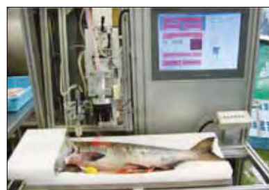
等級判別装置(試作機)による現地計測試験
