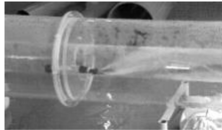
模擬下水道管路を用いた推進制御試験
