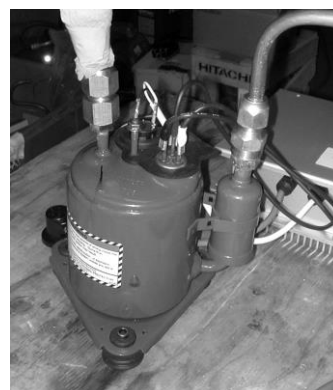
直流電源用圧縮機
