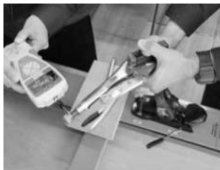
ロードセルを用いた締結トルク計測
