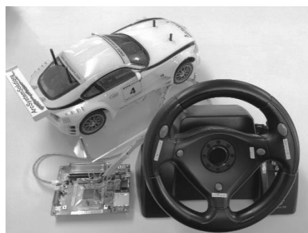
車載ソフト開発を模擬したラジコン制御アプリケーション
