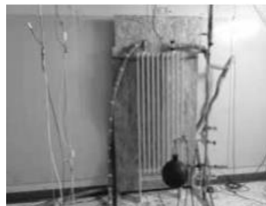
放射パネルの冷暖房能力評価の様子
