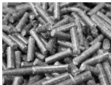
枝・葉・草から製造したペレット燃料
