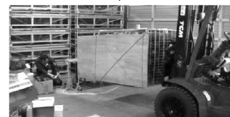
強度試験の様子 （積載物：カボチャ約 400kg）
