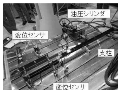
支柱強度試験の様子
