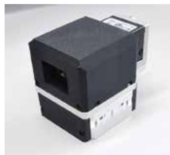
図1 CMOSカメラと複数の光学フィルタで構成した多眼式分光イメージングセンサ (左：外観、右：内部構造)
