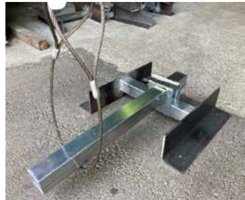
治具に取り付けた試験片
