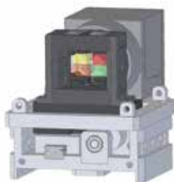
図1 CMOSカメラと複数の光学フィルタで構成した多眼式分光イメージングセンサ (左：外観、右：内部構造)
