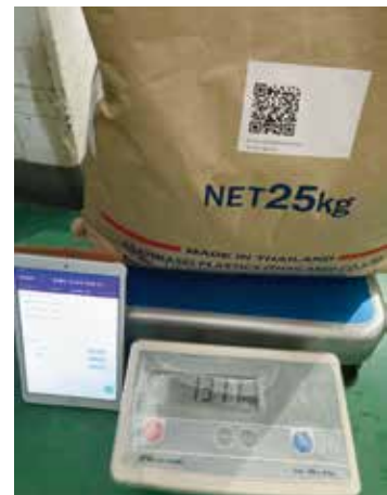
無線重量計とQRコードによる材料の計量
