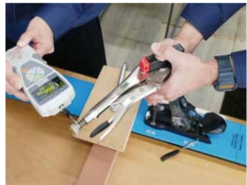
ロードセルを用いた締結トルク計測
