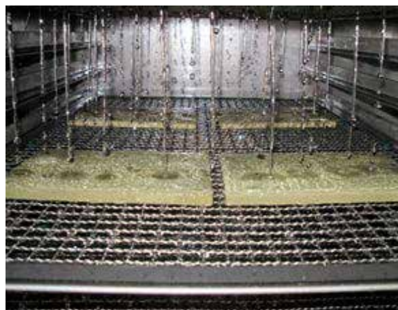
凍結融解試験による耐久性評価 (散水により供試体を融解している。)
