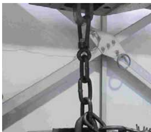
耐荷重試験（引張試験）
