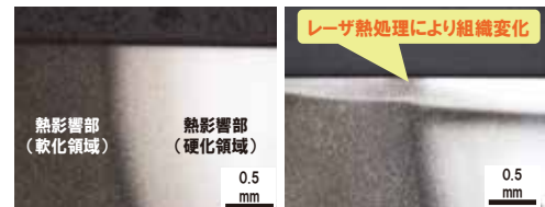
レーザ部分熱処理による断面組織の変化 (左：熱処理なし 右：熱処理あり)
