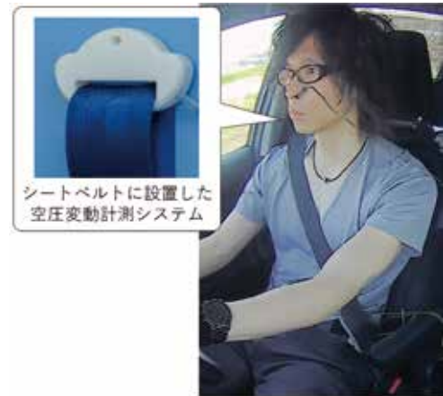
空圧変動計測システムを用いた路上試験
