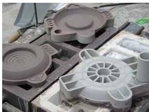
鋳鉄鍋の試作に用いた無機粉末造形鋳型
