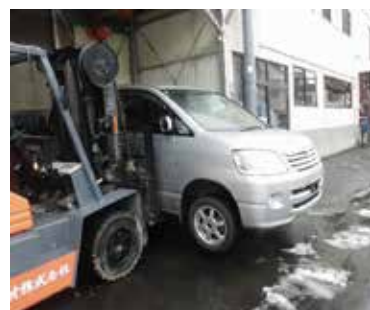
車両を吊り上げて、遠隔操縦 の確認試験を行なう様子
