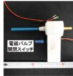
3Dプリンターを用いて試作したハンドガン
