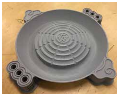
図3. 大型3Dプリンターで試作したジンギスカン鍋
