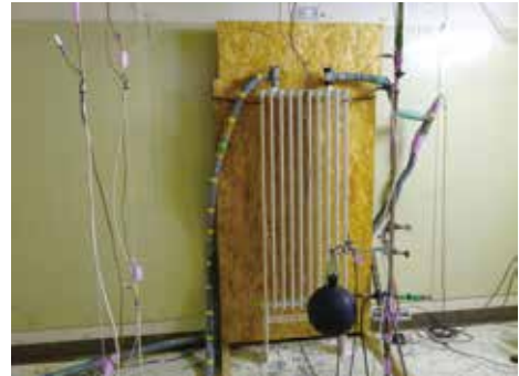
放射パネルの冷暖房能力評価の様子
