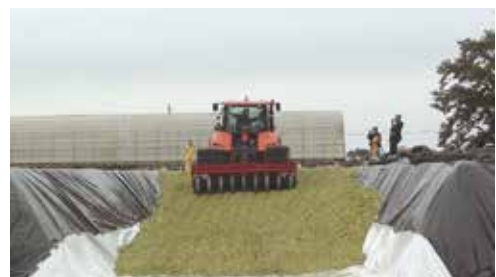
バンカーサイロ内での自動運転試験風景
