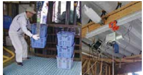
重力補償ウィンチによる コンテナ段積作業の軽労化
