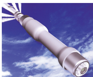
地中埋設管検査・洗浄ロボット (クリーンロボきょうごく)
