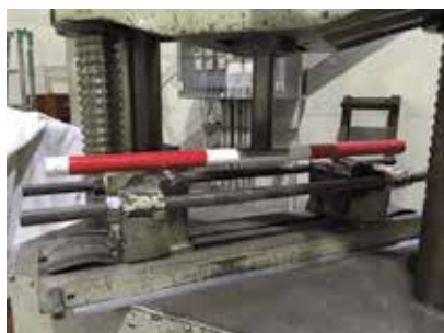
図1 路端標示柱に適用した強度試験
