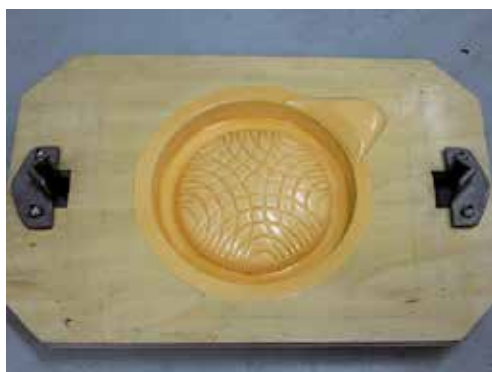
鑄型造型に用いた木型(マッチプレート)
