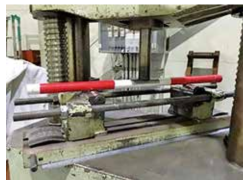
路端標示柱に適用した強度試験
