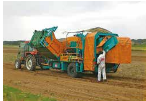
掘取り作業時の油圧負荷計測
