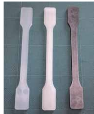
作製した試験片 (樹脂のみ:ガラス繊維強化:炭素繊維強化)
