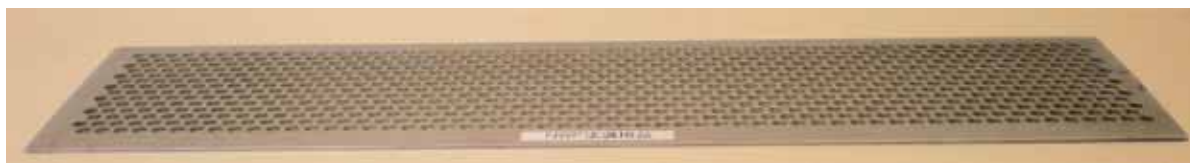
開発した技術によるパンチング加工
