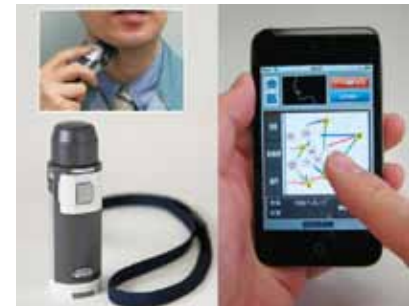
写真② 発話困難者支援のための電気式人工喉頭と音声生成アプリ
