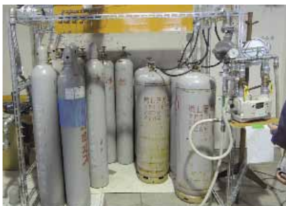
模擬ガス製造装置
