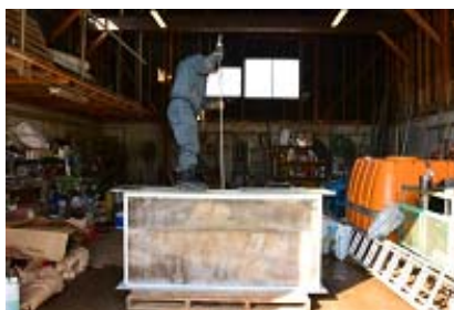
モデル土壌を用いた 打ち込みノズルの試験
