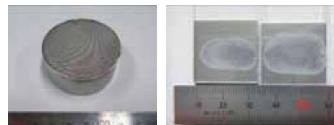
レーザー溶接継手 (左：ステンレスメッシュ 右：樹脂-金属継手)
