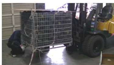
試験の様子（積載物：カボチャ約400kg）
