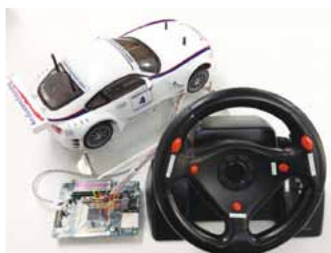
車載ソフト開発を模擬したラジコン制御アプリケーション
