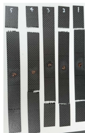
引張試験後の試験片
