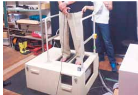
足部固有感覚によるバランス検査装置
