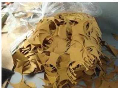
摩擦材の打ち抜き屑
