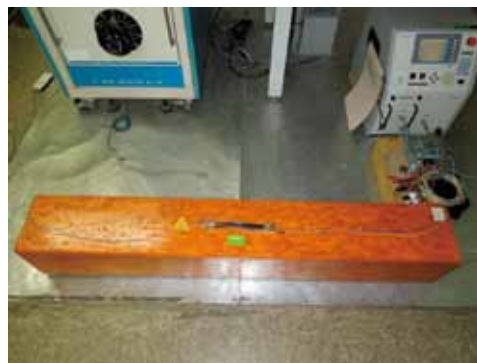
試作ECUの伝導性ノイズ試験風景
