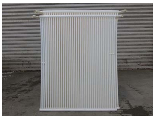
温泉熱回収用プラスチック熱交換器の外観
