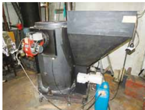
廃ポリスチレンペレット燃焼装置
