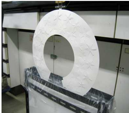
図2 ディップ法による光触媒塗布
