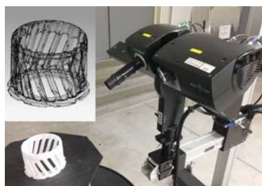
部品の非接触3次元測定
