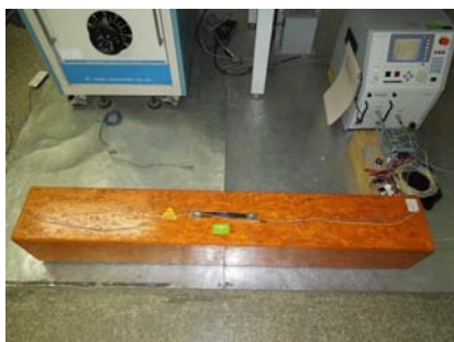
試作ECUの伝導性ノイズ試験風景（EFT/B試験）
