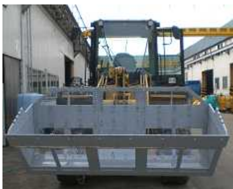
試作した除雪用バケツ
