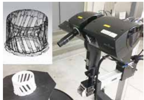
部品の非接触3次元測定
