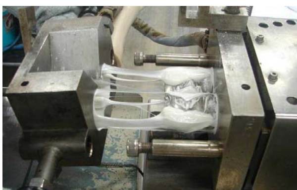
混練特性試験機によるブレンド状況
