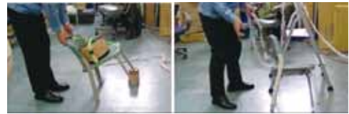
強度試験の様子 (左：前脚上げ、右：落下)
