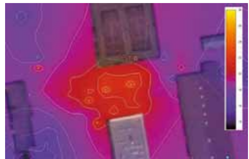
電界計測ツールで計測した 920MHz電界マップ
