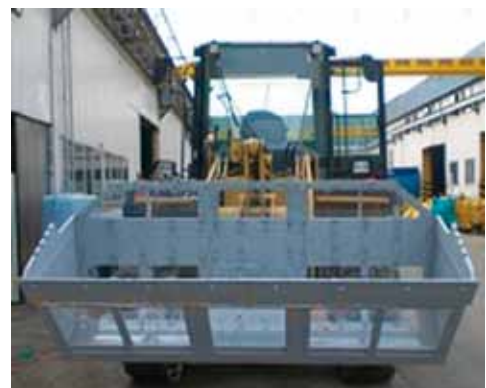
試作した除雪用バケット
