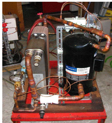
試作ヒートポンプ：出力35kW
