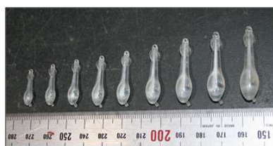
製作した光造形マスター型
