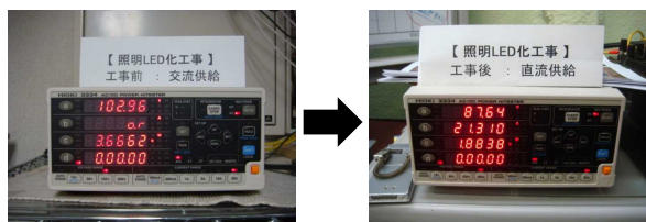
LED 照明化（直流給電）による省電力化
