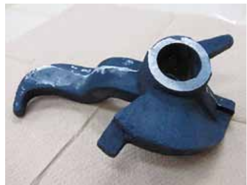
鋳造・機械加工で再生した部品
