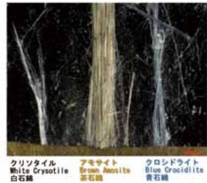
光学顕微鏡によるアスベスト形状の判別
