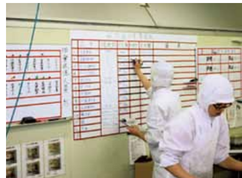
進捗状況が分かる生産管理板
