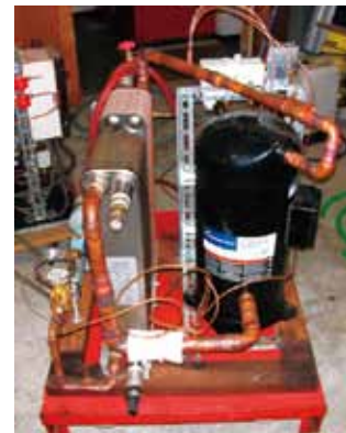
試作ヒートポンプ：出力35kW
