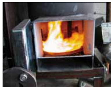
廃不凍液の燃焼状況
