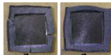
割れが発生 割れ無し
