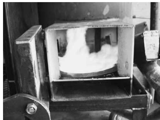
廃不凍液の燃焼状況
