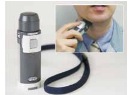
写真② 音声の自然な揺らぎを備えた 新型電気式人工喉頭
