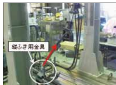
縦ふき用金具の試験状況
