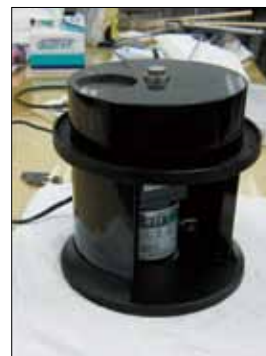
試作した電動式卓上石臼の外観
