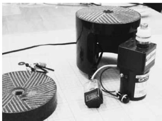
<石臼と電動機構の組み立て>
