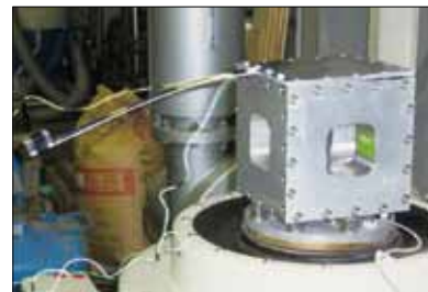
振動試験装置による発電(蓄電)試験風景
