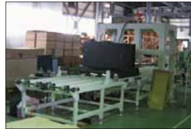
開発を行った針葉樹合板節脱落防止処理装置
