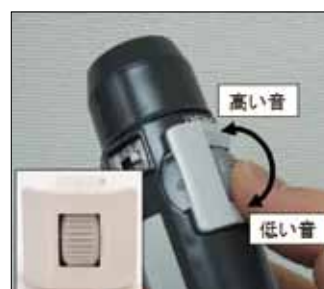
指で抑揚を制御できる新型操作ユニット
