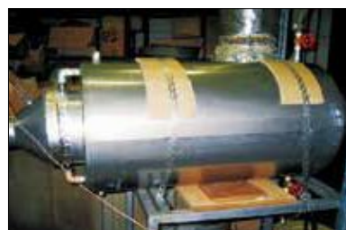
廃熱回収用熱交換器
