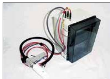
ハンディ型身色等級判別装置 製品プロトタイプ機
