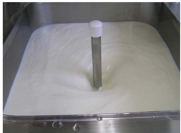
耐熱性菌等の残存している菌が増殖しないように、次の工程への移行を迅速に行う。発酵に適した温度になるように管理する。殺菌終了後、冷水で間接的に40℃まで冷却。
