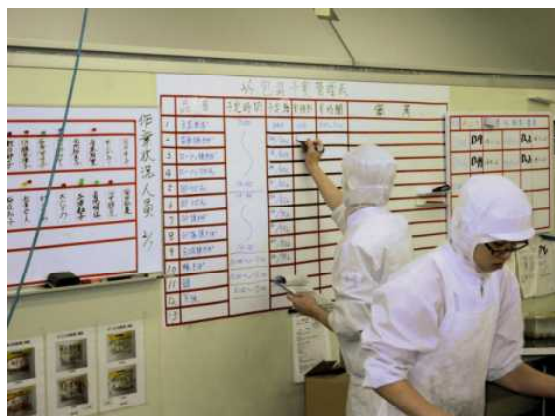
進捗状況が分かる生産管理板
