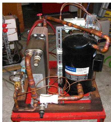
試作ヒートポンプ：出力35kW
