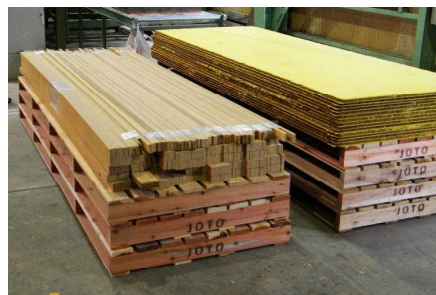
試作したボードと 切断加工により作製した胴縁
