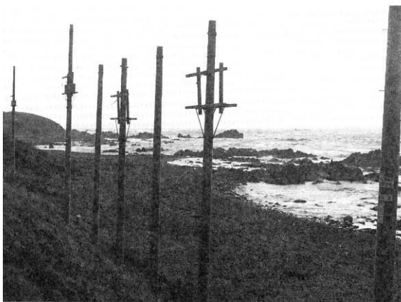
写真 4 PC ポールの暴露試験
