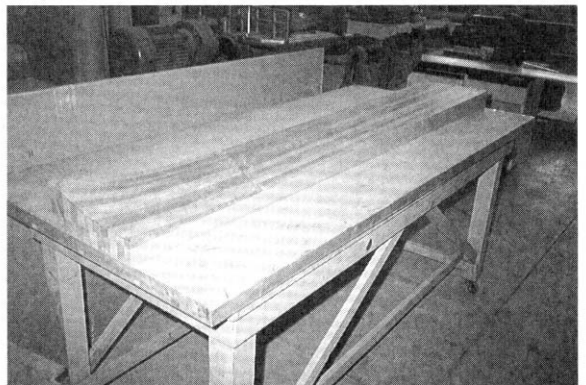
写真6 アサダ材による型枠ベース台
