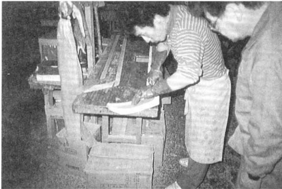
写真9 接着剤塗布と型入れ
