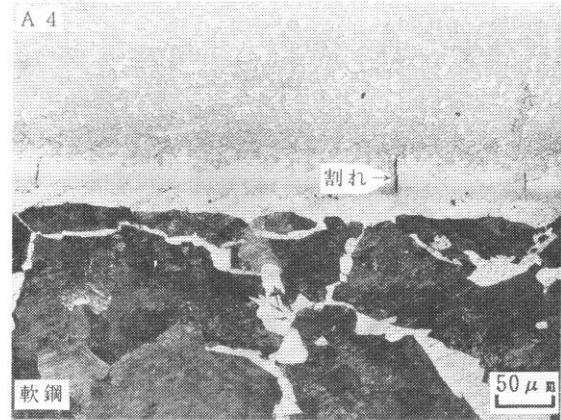
写真8 破断部近傍の断面組織 (軟鋼を使用)
