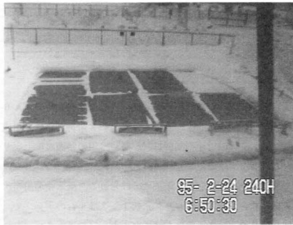
写真 1 - 4 融雪状況 (電気方式・90分後)
