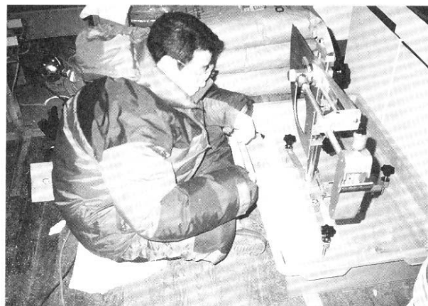
写真7 低温室内ですべり抵抗値を測定している状況
