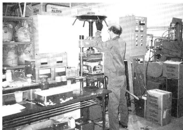
写真3 型枠の中へ雪を入れ，プレスにて圧雪している状態
