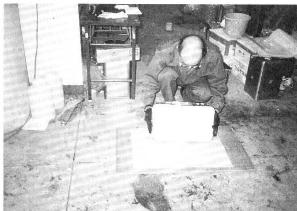
写真4 プレス後型枠より脱型している状況
