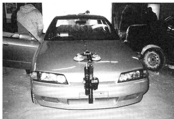
写真 11 試験車の前側に非接触型速度計のレンズ部
