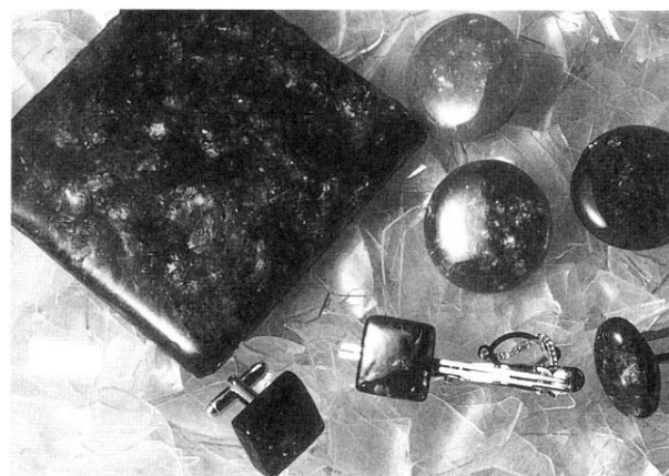
図9 装飾タイル、アクセサリーの試作品 下地はカレット
