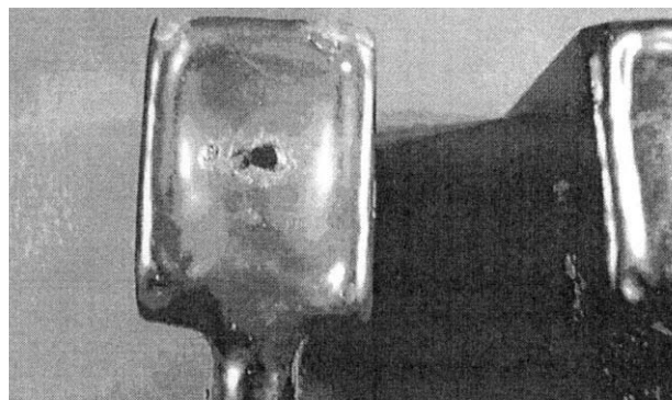
図9 放熱パネル側面部の腐食
