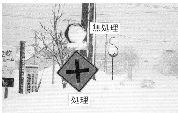
写真1 道路標識への応用例
