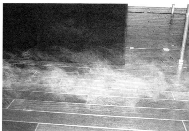
写真2 白煙によるコールドドラフトの可視化 (Low-Eペアガラス：外気温度-10℃)
