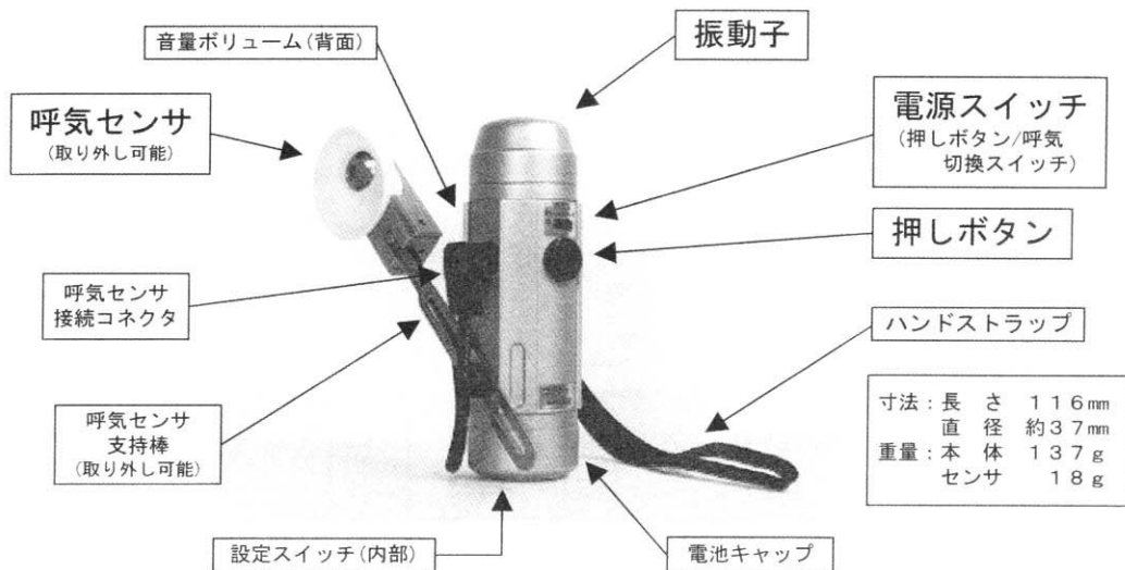
図4 製品化した電気式人工喉頭
