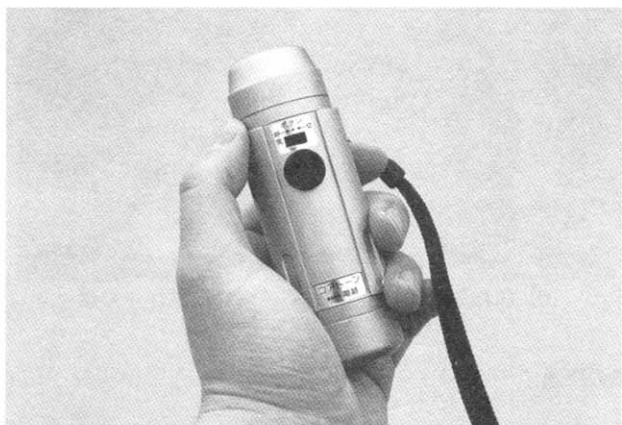
図5 呼気センサを取り外した状態
