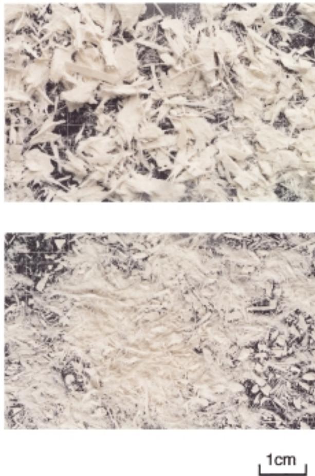
上段：スクリーン径10mm 下段：スクリーン径3mm 図8 SMCの碎成物
