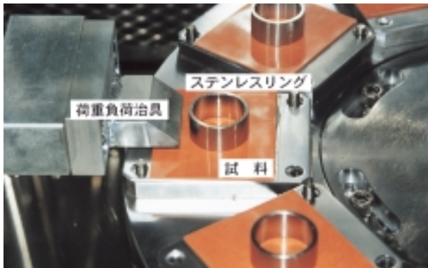
図5 氷の付着力測定装置の概要
