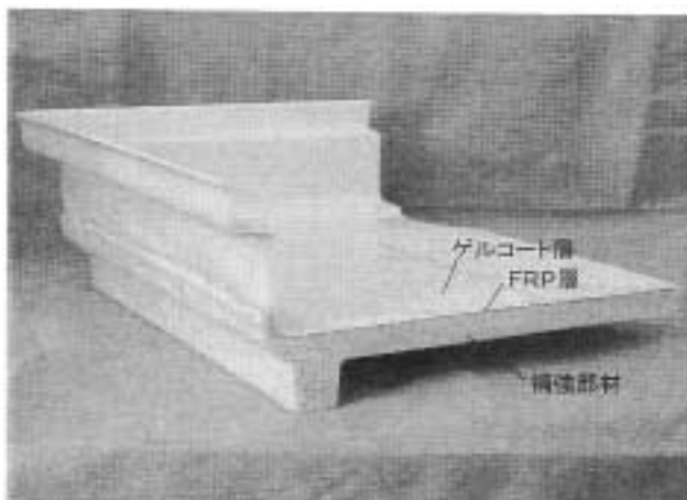
図13 試作した浴室用防水パンのカットサンプル
