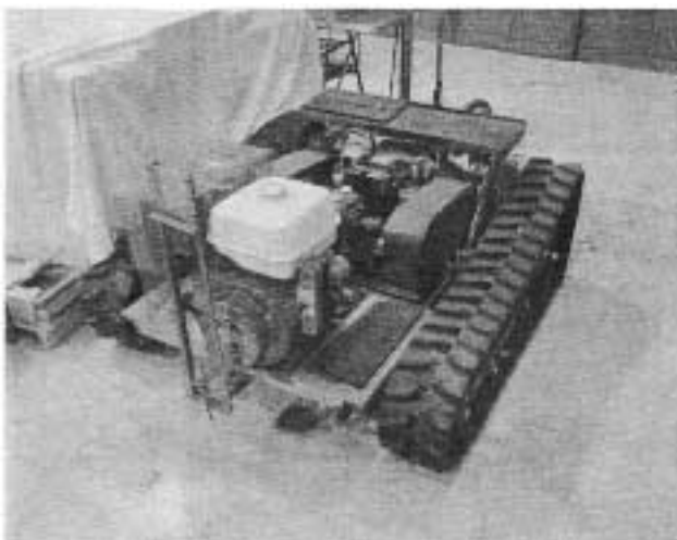
図 2.5 8 P S 小型履帯トラクタ
