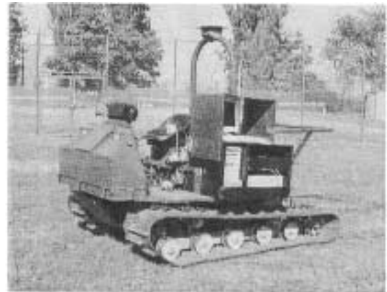
図 2.6 25 P S 市販履帯トラクタ
