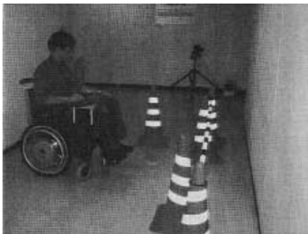
図7 旋回走行-停止時の試験
