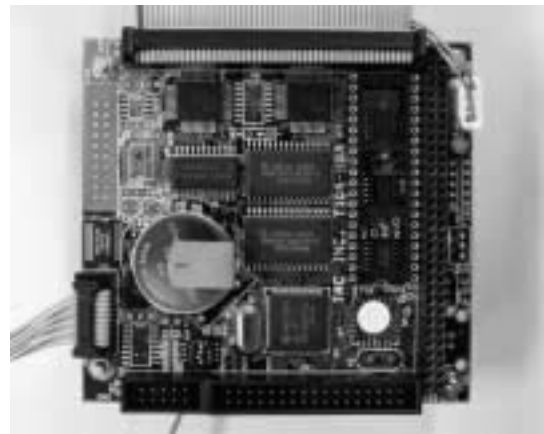
図6 酪農機器の通信制御に用いたマイコンボード
