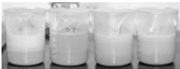
図3.9 酸浸出後5.5日間静置した脱脂未乾燥物 左から硫酸0v/v%(pH6.3), 0.1v/v%(pH4.2), 0.3v/v%(pH2.4), 0.5v/v%(pH1.7)
