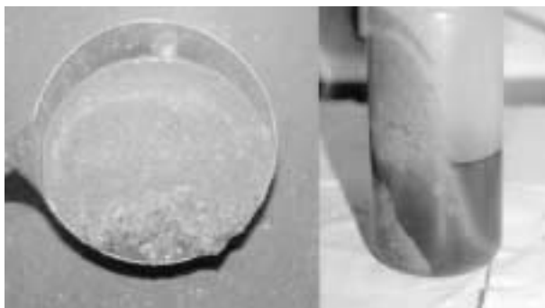
図3.2 圧力鍋による加熱脱脂試験 (左：加熱後のイカ内臓，右：8500G-30分遠心分離後)
