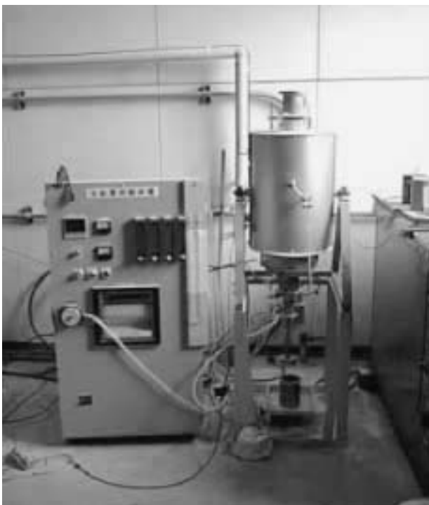
図6 流動層を用いた発泡セラミックス実験炉
