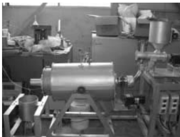
図9 ロータリーキルン炉の外観
