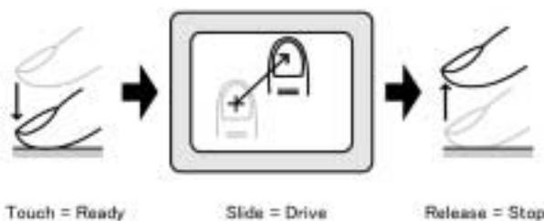
図6 タッチパッドコントローラの操作方法
