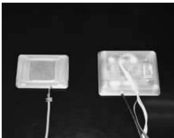
図1 タッチパッド型電動車椅子コントローラ
