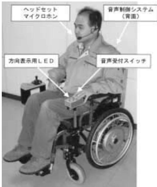
図5 音声操作型電動車椅子
