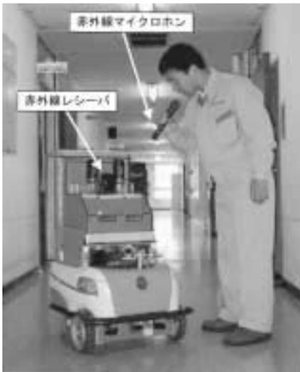
図1 自律型走行ロボットの音声指示システム
