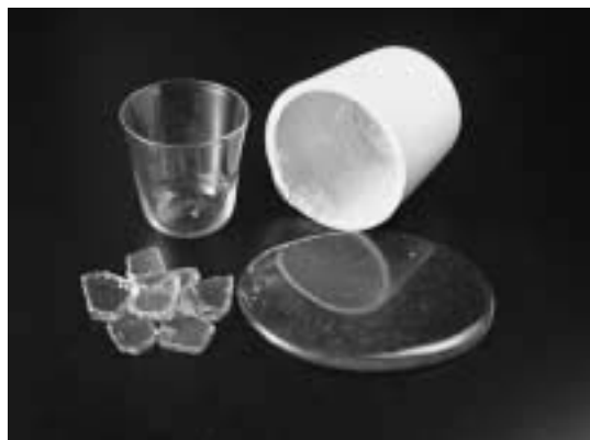
図5 左上：ファンネルより試作したコップ， 右上：るつぼ，左下：カレット， 右下：ファンネル溶融ガラス
