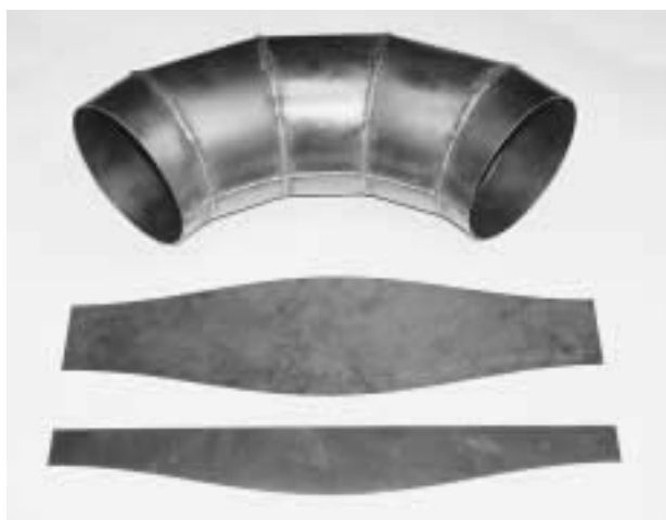
写真15 板金展開 NC 加工システム
