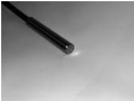
図5 光ファイバ先端部
