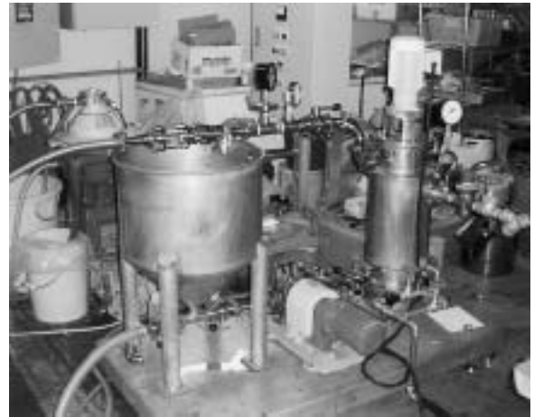
図 2.2 連続式加熱装置
