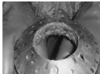
図 3.3 ミートチョッパーによるイカ内臓の破碎
