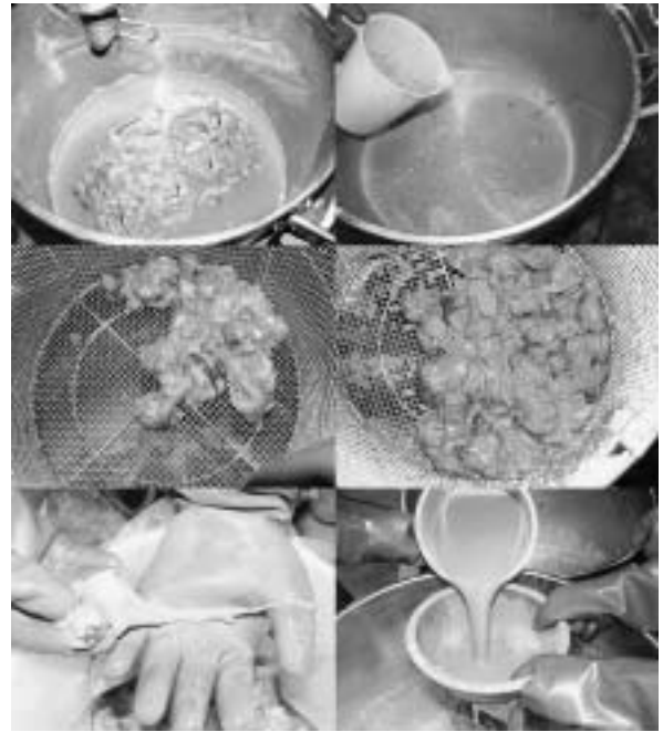
図 3.2 ゲソ部分分離法による内臓部分のスラリー化
