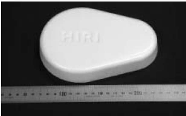
図 21 ギアカバーの発泡模型（表面）
