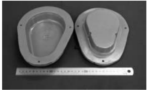
図 19 ギヤカバー金型 (左：キャビティ、右：コア)
