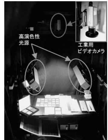
図4 開発した撮像素子型センサ
