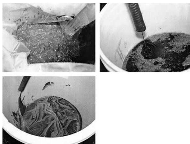
図 3.2 脱脂工程で得られた分離物 左上：スラッジ，右上：油脂分，右下：重液
